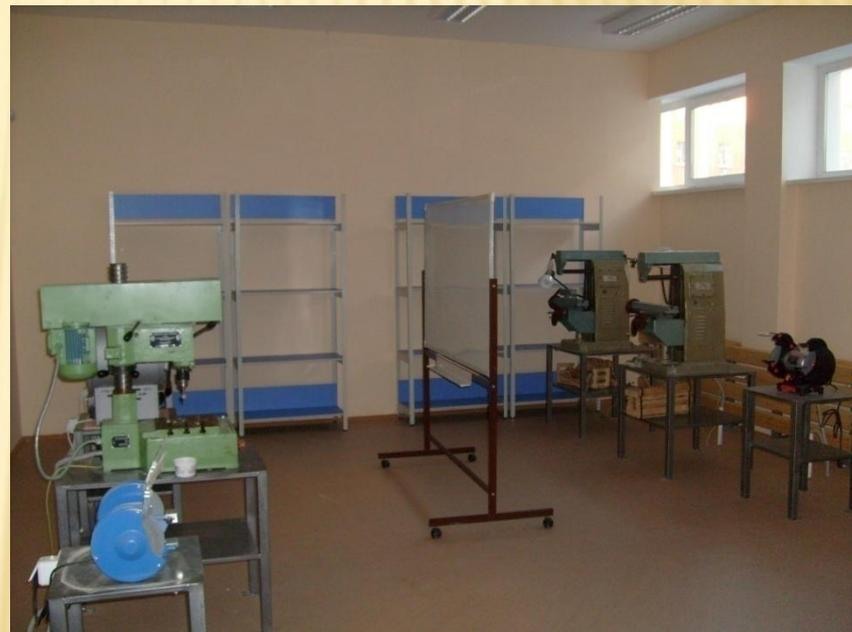
**Установлены: 2 горизонтально-фрезерных станка, 2 заточных станка Эт-175, настольно-сверлильный вертикальный станок, станок «Корвет- 497», верстаки слесарные в комплекте (тиски, экран, регулируемый табурет), 5 муфельных печей.**
